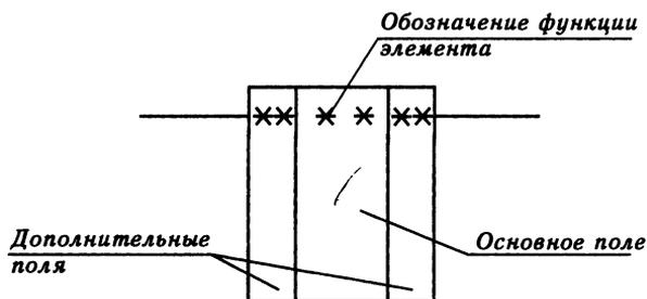
Рис. 1.6.8. Обозначение двоичных логических элементов на схеме
